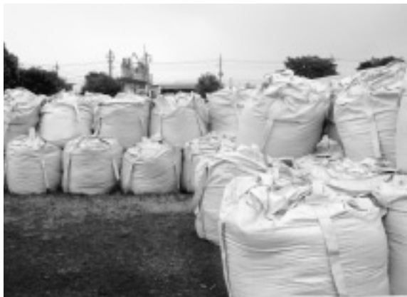
山積みになった下水汚泥の焼却灰
